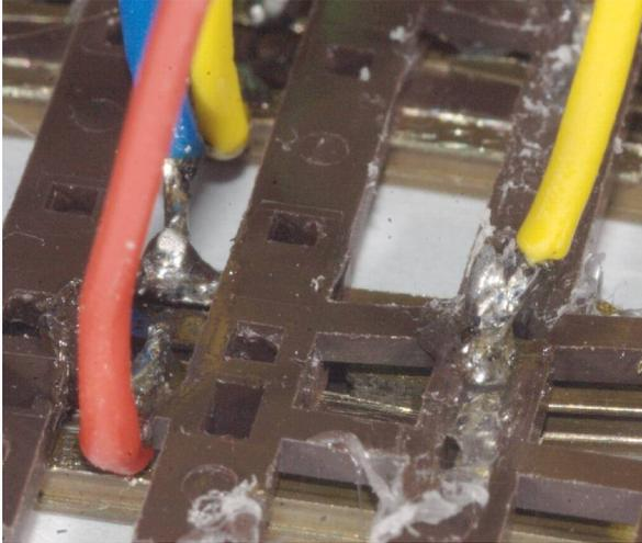
Bei allen Lötungen an den Schienen muss vorher die Brünierung entfernt werden. Dies kann z.B. mit einem kleinen Messer erfolgen. Die Anschlusslaschen der Herzstücke werden unverändert verwendet. An den inneren gebogenen Zungen wird jeweils ein Anschlussdraht verlötet. Dies sind der blaue und gelbe Draht links im Bild. Ausserdem wird in der Mitte der Weiche die Backenschiene freigelegt und mit den direkt daneben liegenden äußeren gewinkelten Zungen verbunden (roter Draht).
